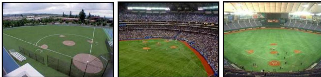
3) Construit en synthétique pour le champ intérieur en réservant des parties de terre pour le tour des bases, le monticule et la piste d'avertissement. La partie du champ extérieur en herbe naturelle permet aux joueurs de plonger facilement pour attraper les balles. Avec les nouvelles qualités de synthétique cette option tend à disparaître.
